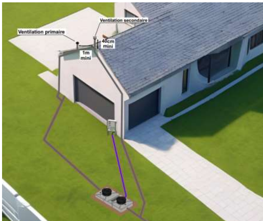
Figure 35 : Ventilations de la filière GINETT
