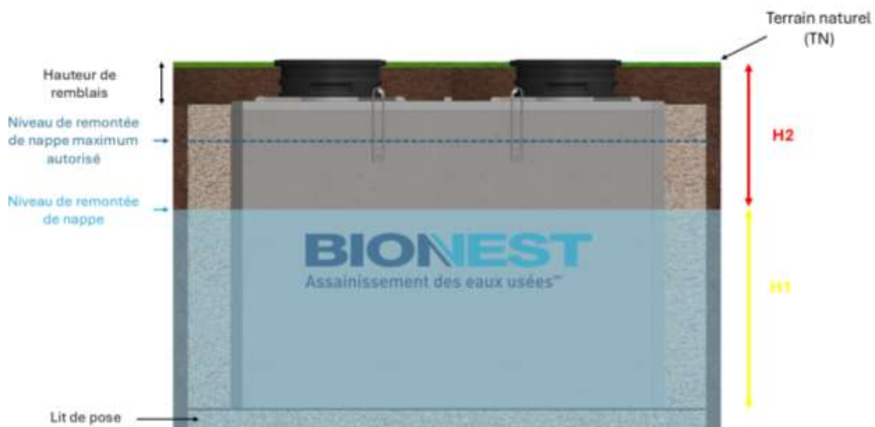
Figure 25: Hauteur d'eau admissible avant risque de flottaison des cuves
