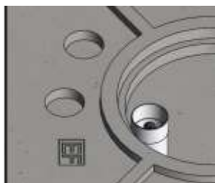
Figure 36: Réservations éventuelles sur cuve béton pour ventilation secondaire
