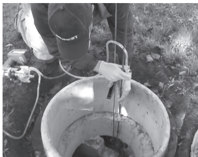
FIGURE 12-4 : INSTALLATION DU DISPOSITIF DE FIXATION DE L'ÉCHANTILLONNEUR PONCTUEL
