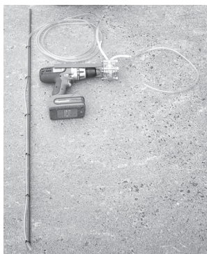
FIGURE 12-4 : INSTALLATION DU DISPOSITIF DE FIXATION DE L'ÉCHANTILLONNEUR PONCTUEL
